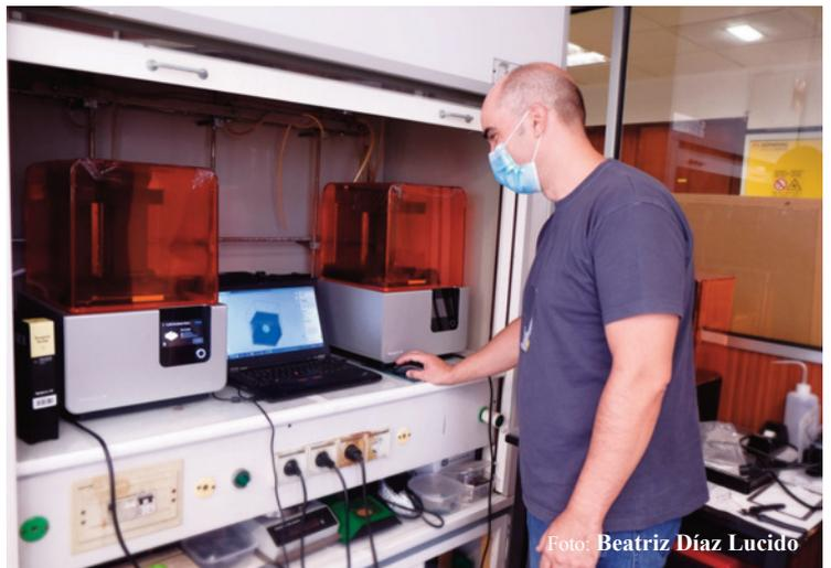
lo que permite disponer del producto final en poco tiempo y reproducirlo cómodamente. Aunque la fabricación por inyección permite mayores tiradas, la impresión por 3D es más ágil a la hora de rediseñar el producto final. Además, la impresión 3D no requiere rellenar el producto por completo, lo que da más ligereza al producto final y ahorra en material.
